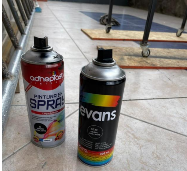
Figura 27: Pintura negra para las paredes exteriores del destilador
