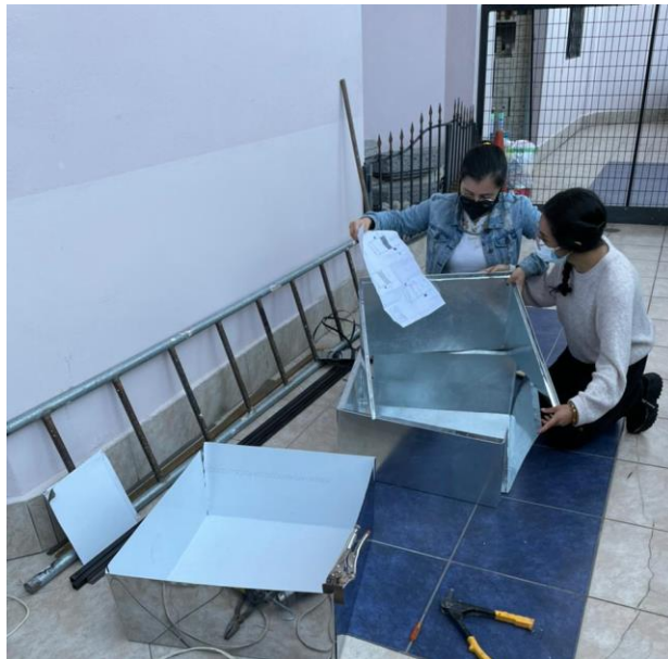
Figura 24: Encaje de la bandeja y las paredes superiores del destilador con acero inoxidable y tol galvanizado
