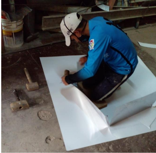
Figura 21: Dobles de la plancha de acero inoxidable
