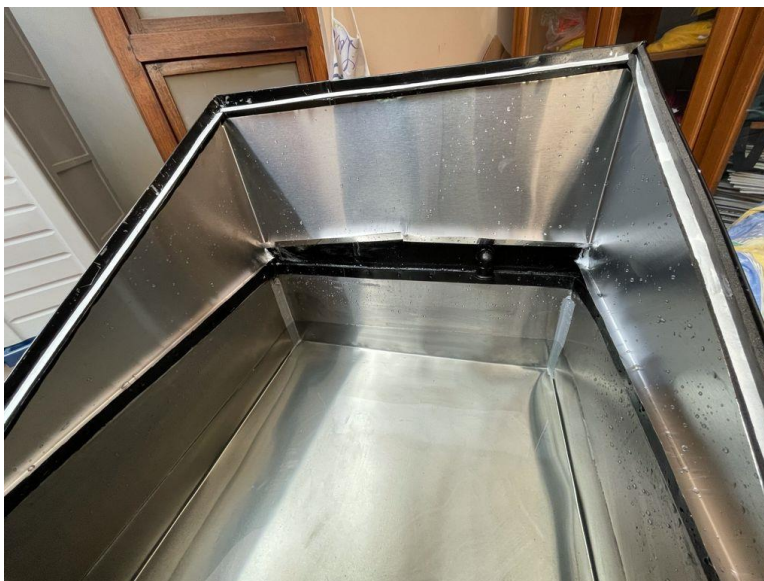
Figura 32: Implantación del ajuste de acero inoxidable a parte superior de las paredes
