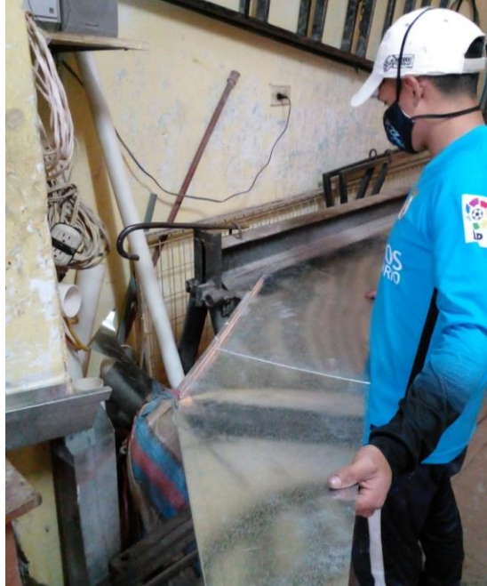
Figura 23: Dobles de las paredes superiores del destilador con acero inoxidable
