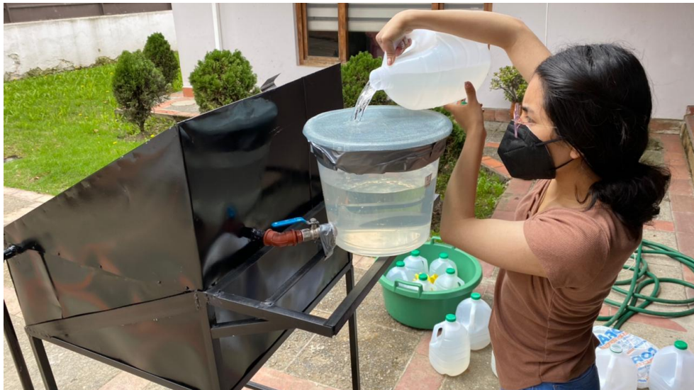
Figura 36: Ingreso de agua de rio al destilador
