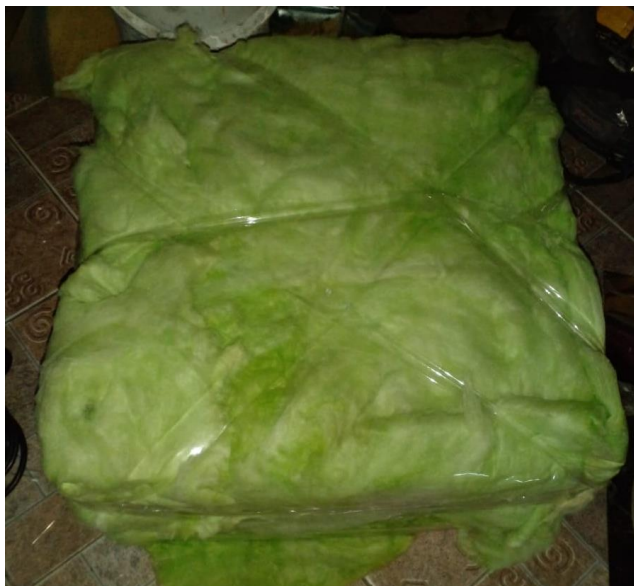
Figura 25: Lana de vidrio como aislante térmico
