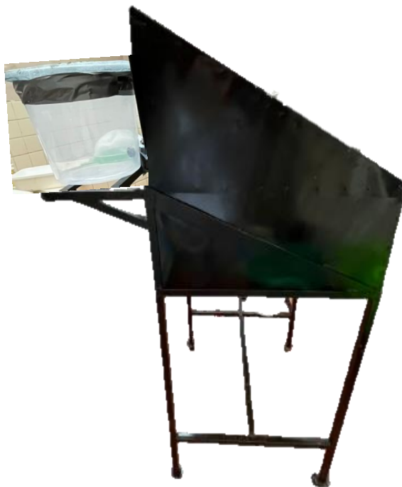
Figura 8: Vista lateral izquierda del destilador solar
