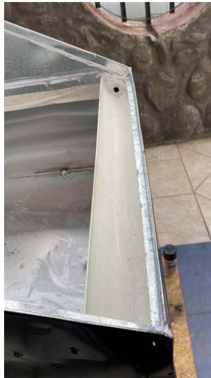
Figura 30: Canaleta principal de recolección de agua destilada
