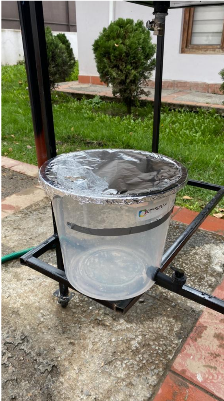
Figura 39: Tanque recolector de agua destilada
