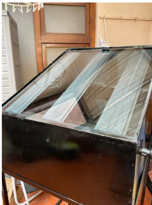
Figura 33: Implementación de tiras de aluminio al vidrio
