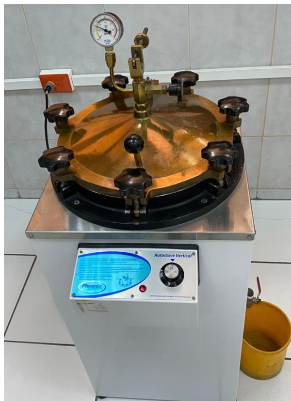
Figura 41: Equipo autoclave para esterilizar los materiales
