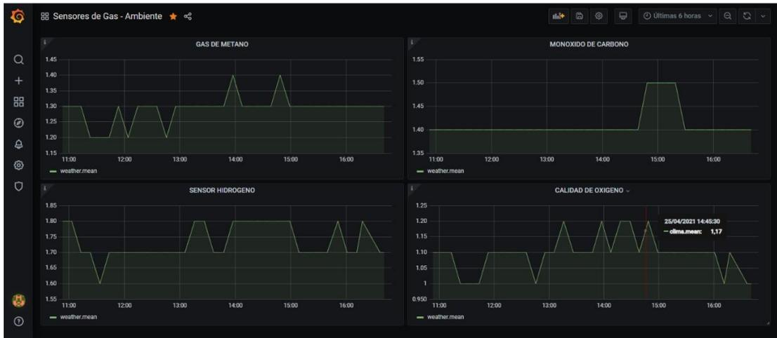
Figura 4.11 Sensores de gases vistos desde Grafana
