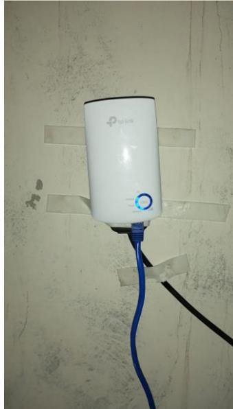
Figura 3.68 Extensor WIFI para incrementar señal inalámbrica
