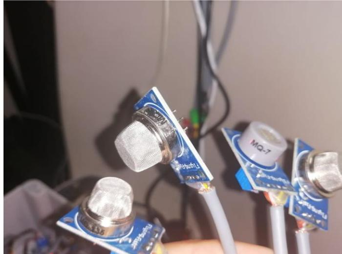
Figura 3.61 Sensores de gases
