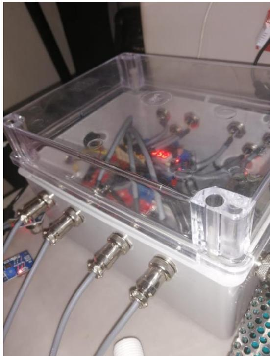
Figura 3.60 Conectores de sensores
