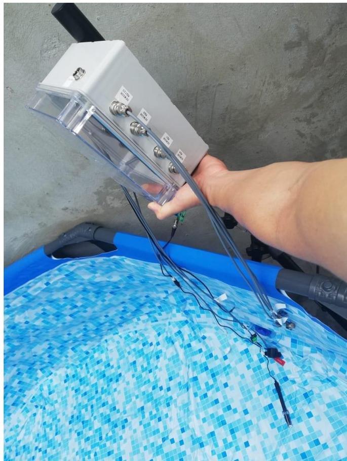
Figura 3.50 Colocar sensores en piscina
