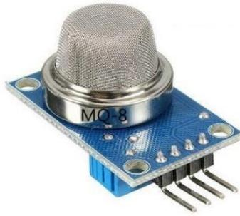
Figura 3.20 Sensor de hidrógeno
