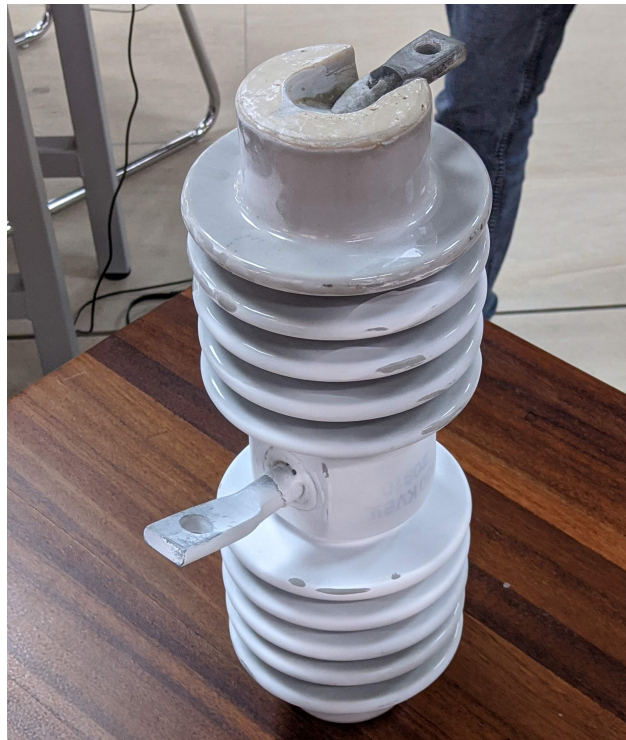
Figura 56: Capa de aerosol antirreflejante en la parte cerámica del seccionador (Fuente: Autor)
