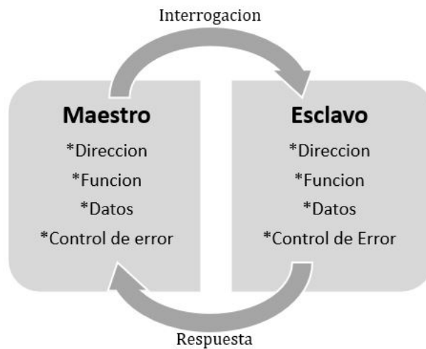
Figura 29: Comunicación entre maestro y esclavo en MODBUS (Fuente: (Diselecser, 2020))
