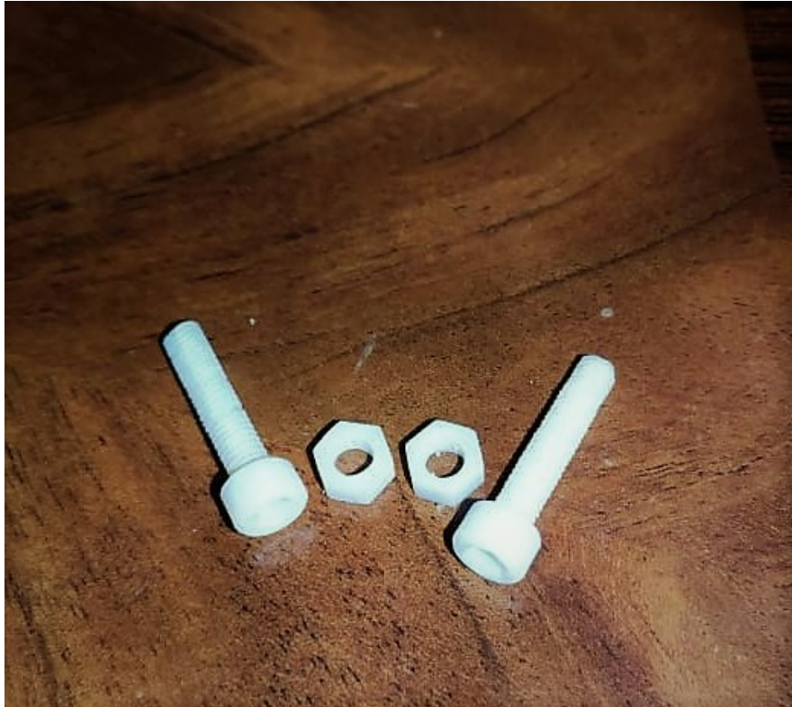
Figura 70: Pernos allen y sus respectivas tuercas impresos en resina Verowhite (Fuente: Autor)
