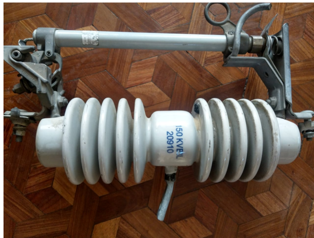
Figura 2: Ejemplo de un Seccionador eléctrico 22kV (Fuente: Autor)
