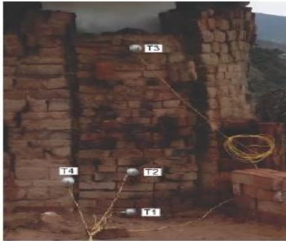
**Figura 12.** Termocuplas en distintos puntos del horno. **Fuente:** [10]
