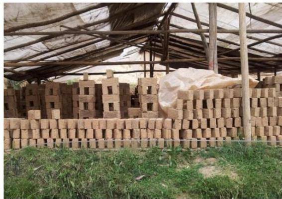
*Figura 5. Secado del ladrillo. Fuente: [8]*
