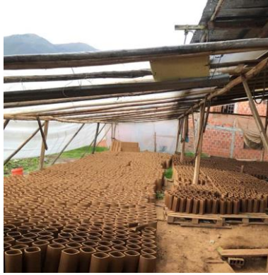
Figura 34. Secado de la teja en galpones. Fuente: Autor.
