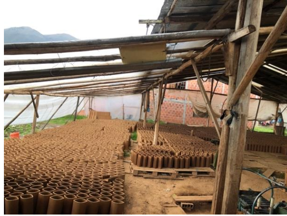
Figura 1. Secado Natural Tejas. Fuente: Autor.
