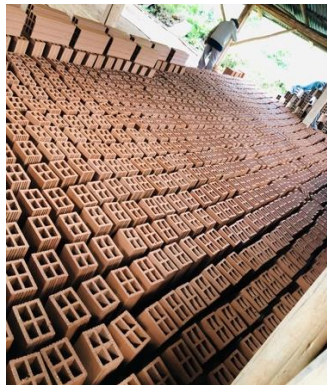
Figura 33. Pre-secado de ladrillo después de la extrusión. Fuente: Autor.
