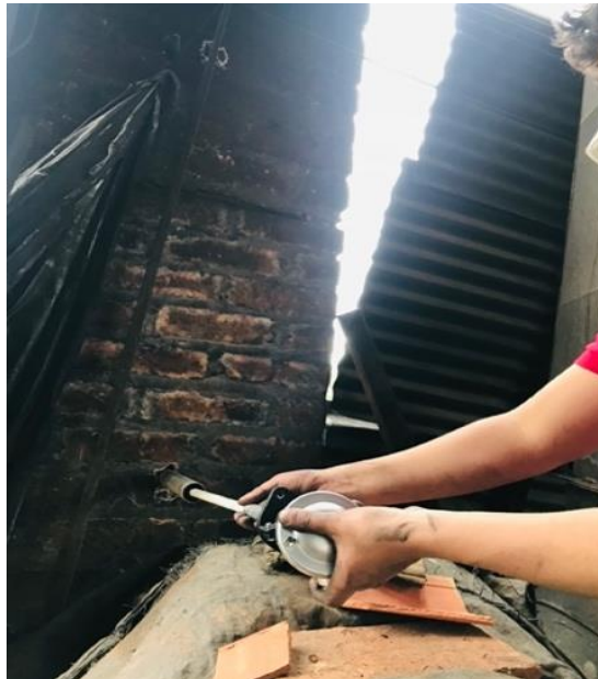
Figura 50. Extracción de la Termocupla después de la quema. Fuente: Autor.
