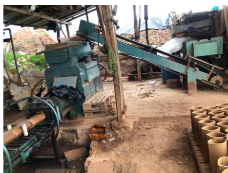
Figura 30. Chancado y batido de la mezcla. Fuente: Autor.
