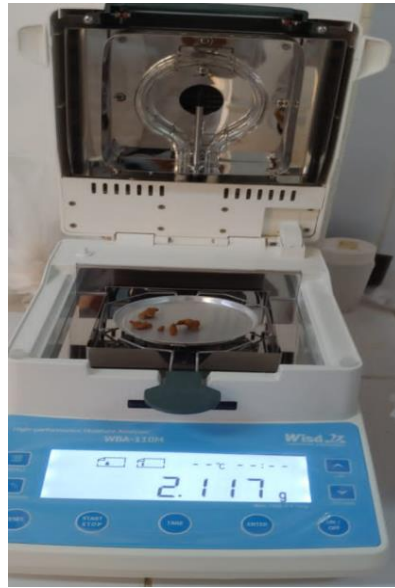
Figura. 73. Obtención de la humedad de ladrillo hueco y teja mediante el método directo. Fuente: Autor.
