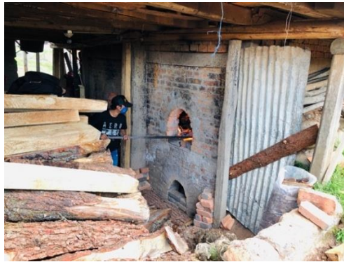
Figura 43. Alimentación de la cámara de combustión sin ninguna medida de seguridad. Fuente: Autor.
