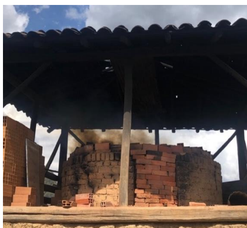
Figura 45. Horno Circular emanando gases hacia el medio. Fuente: Autor.
