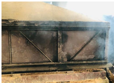
Figura 44. Perdida de calor por escape de los gases. Fuente: Autor.
