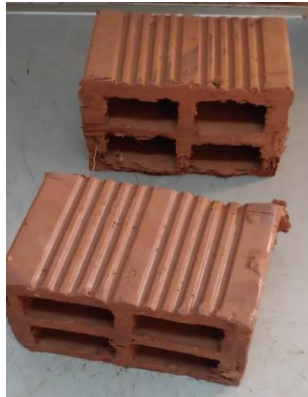
Figura 71. Preparación de la probeta del ladrillo hueco. Fuente: Autor.
