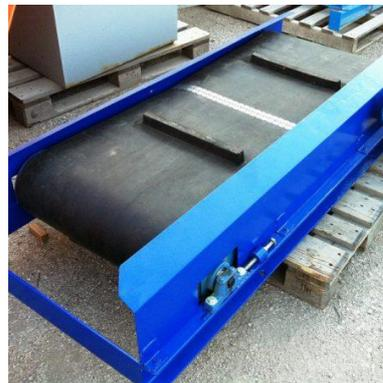
**Figura 13. Banda Transportadora (Vulcabar, n.d.)**
