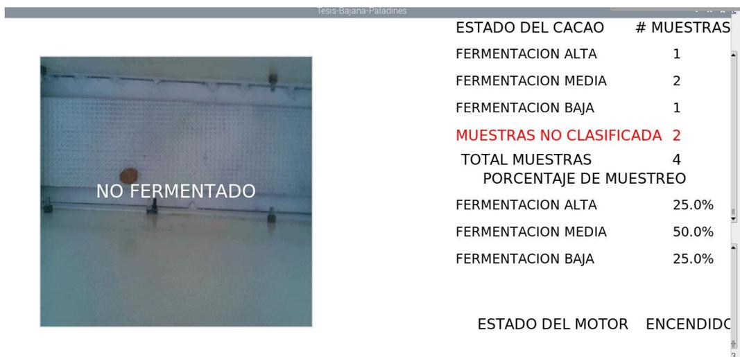
**Figura 80. Detección de un grano de cacao no fermentado**
