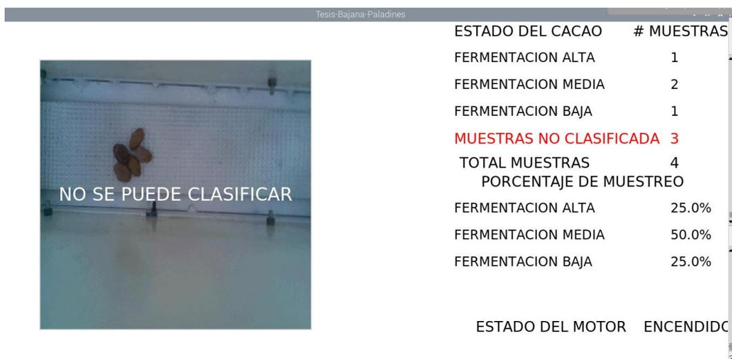
**Figura 82. Detección de objetos que no se pueden clasificar**
