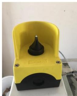
Figura 16. Selector dos posiciones Siemens
