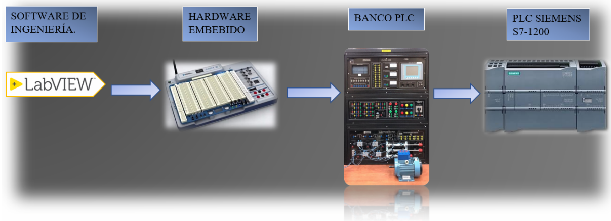
Figura 7: Descripción del Enlace LabVIEW-PLC-ELVIS III
