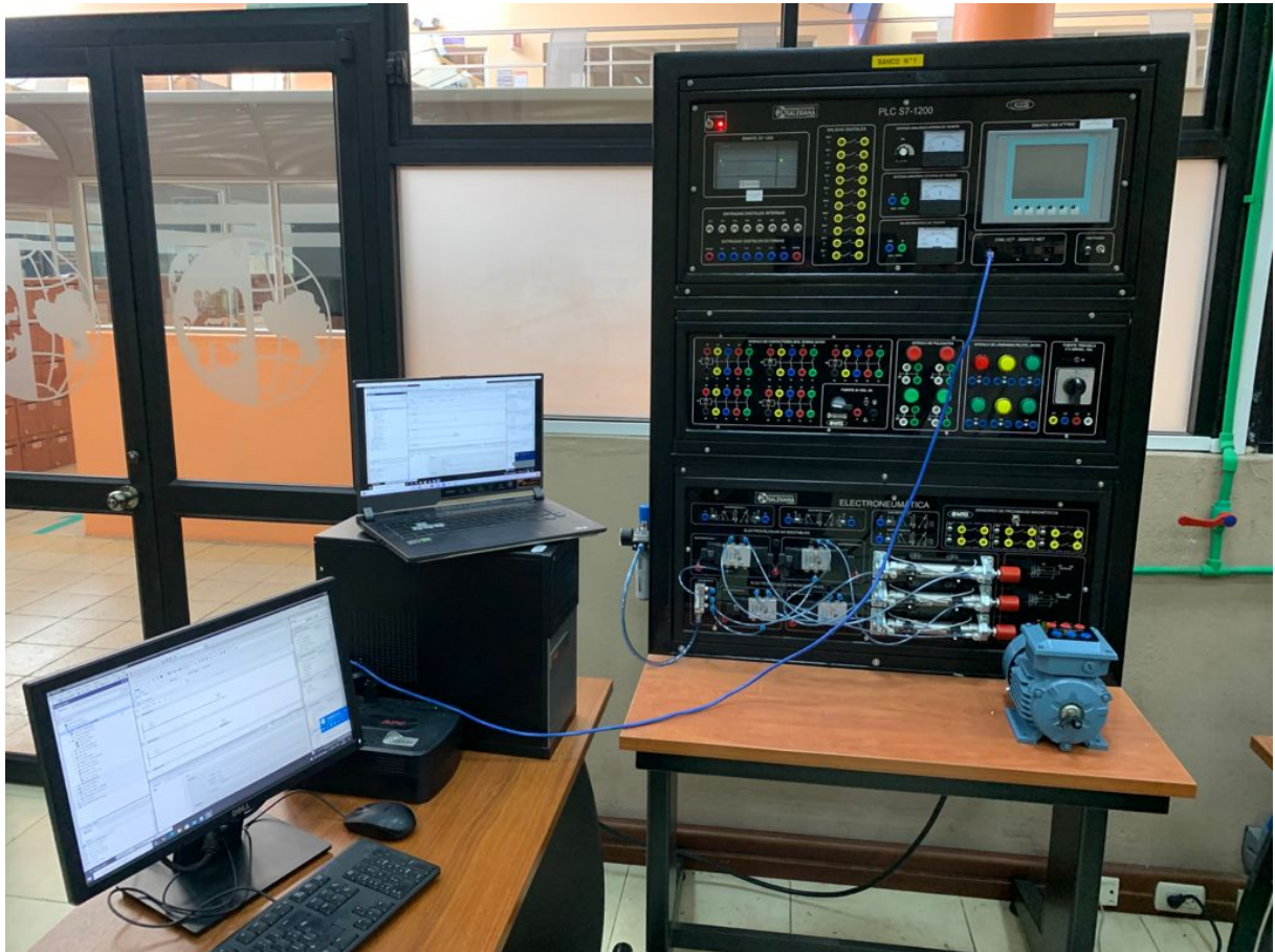
Figura 30: Comunicación remota desde un ordenador hacia el banco PLC
