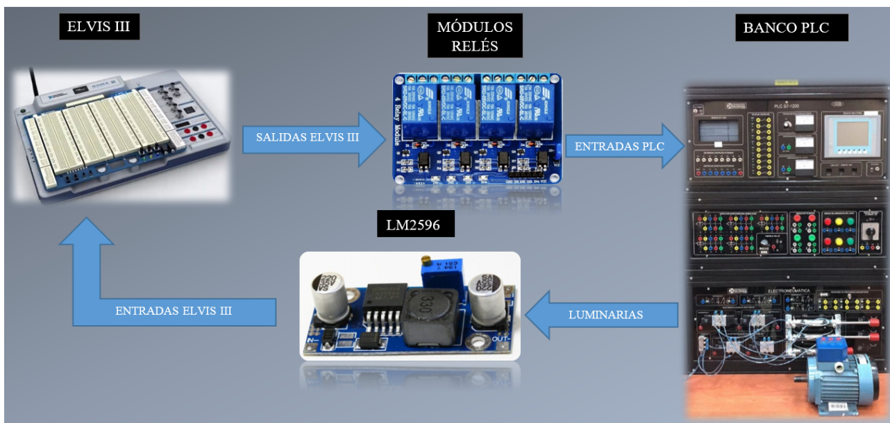
Figura 11: Enlace PLC-ELVIS III con módulos relés y reguladores de voltajes
