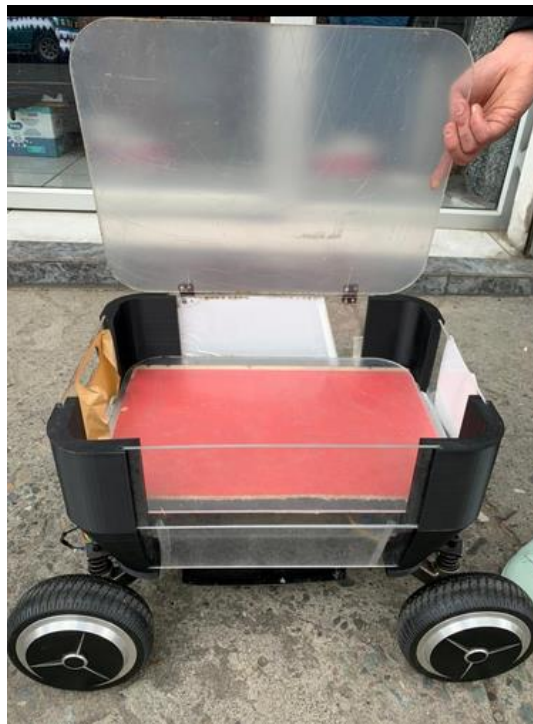
Figura XVI. Impresión 3D de la carcasa.
