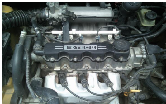
Figura 3.2 Motor del Chevytaxi
