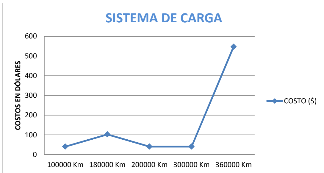
Figura 3.12 Costos de Mantenimiento del Sistema de Carga.
