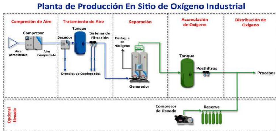
Figura 5: Proceso de separación de aire por el método de adsorción.
