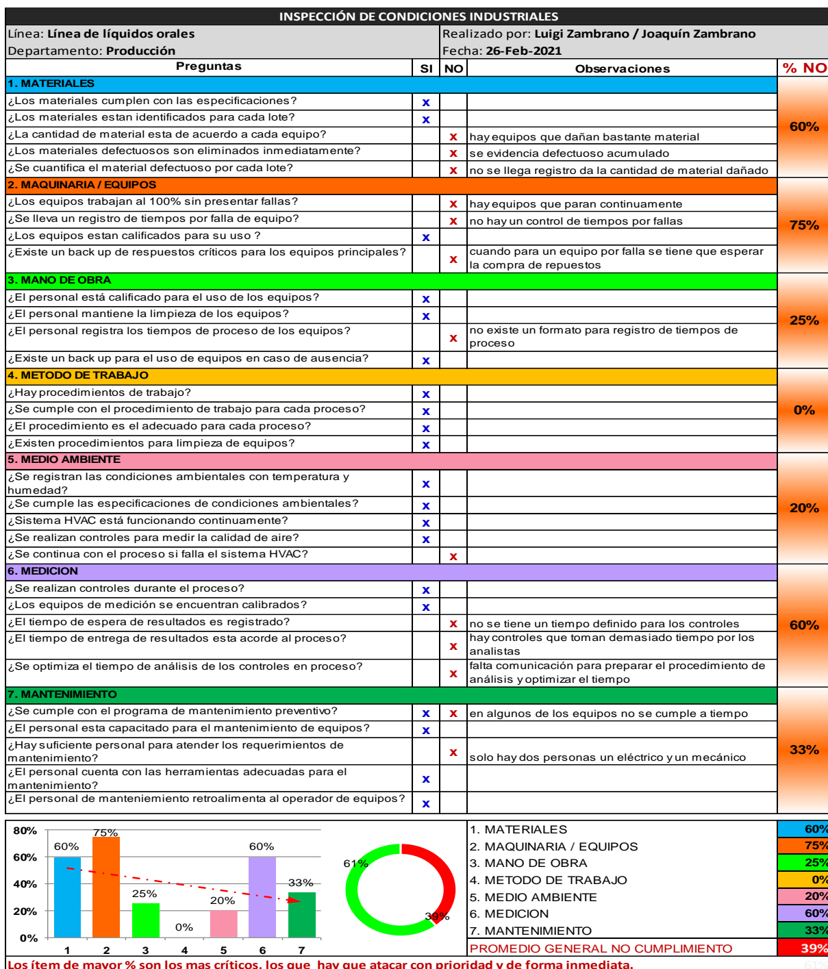
Figura 14: Inspección de condiciones industriales
