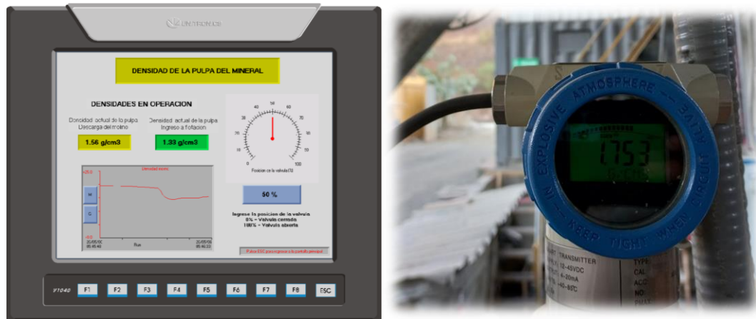
Fig. 79 Visualización de valores de densidad en el sensor y panel HMI
