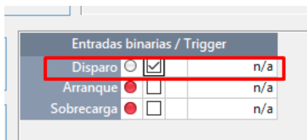
FIGURA 60: ACTIVACIÓN DE DIPARO PARA LA PRUEBA
