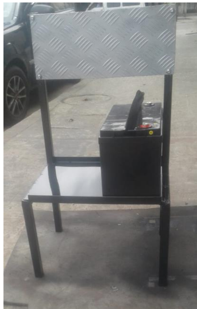
Figura 61.- Base metalica utilizada para los equipos Fuente: Autores
