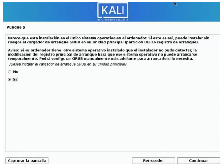
Figura 160. Instalación de arranque GRUB
