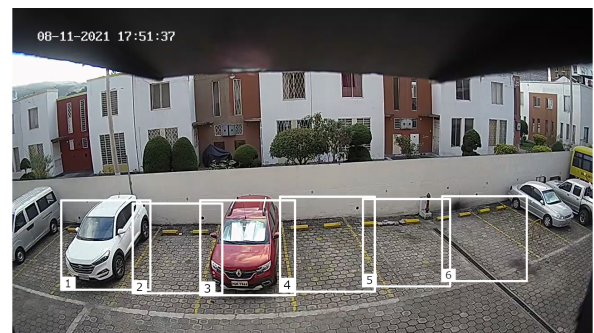
Fig. 6: Imagen de cámara IP con regiones en cada espacio para parqueo
