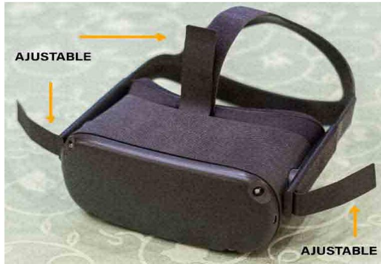
Figura 10.2: Velcros laterales y superior del equipo Oculus Quest para ajustar la posición de la cabeza del jugador
