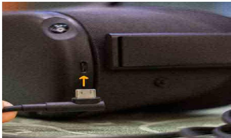
Figura 10.3: Cable tipo C y conector en el equipo Oculus lateral izquierdo
