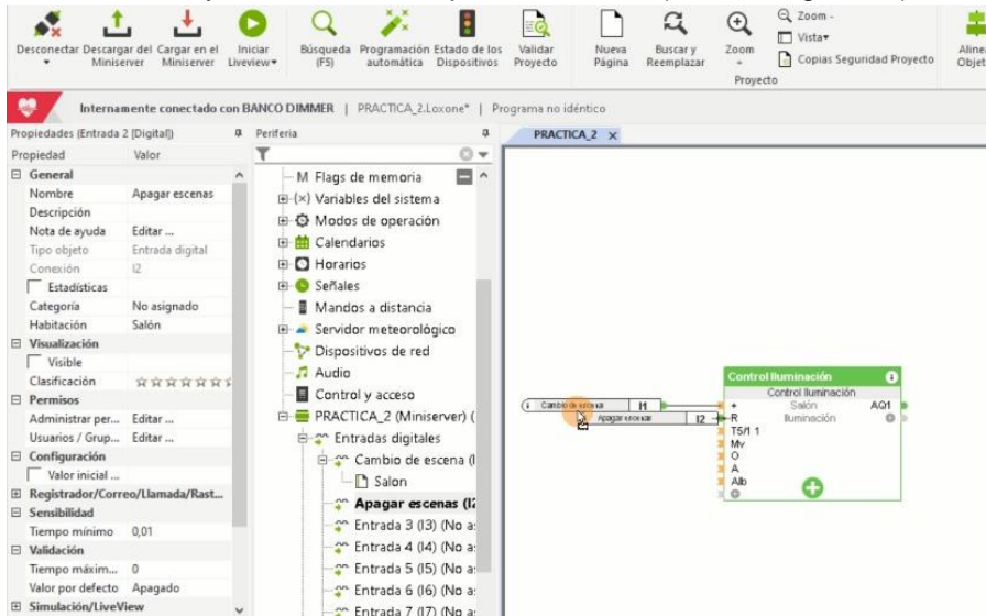
Figura 28. Asignar las entradas al bloque de iluminación.
