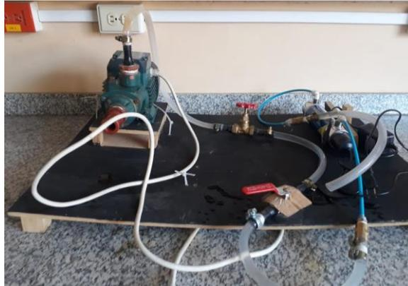
**Imagen 8.** Bomba de agua conectado a la lámpara UV de baja presión
