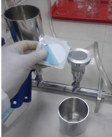
**Imagen 23.** Colocación de la membrana millipore en el sistema de filtrado.
