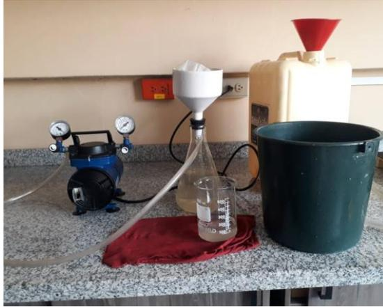
**Imagen 11.** Sistema de filtrado para retirar partículas presentes en el agua residual.
