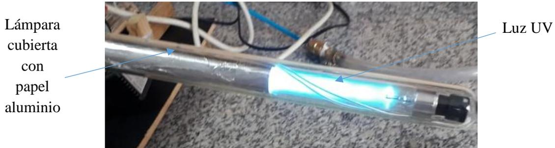
**Imagen 5.** Luz ultravioleta que emite la lámpara de baja presión.
