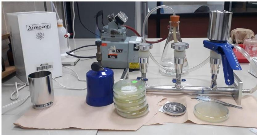
**Imagen 22.** Equipo de filtración por membrana.
