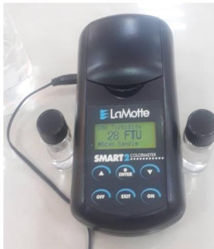
**Imagen 13.** Turbidímetro portátil.
