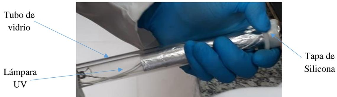
**Imagen 4.** Lámpara ultravioleta dentro del tubo de vidrio.
