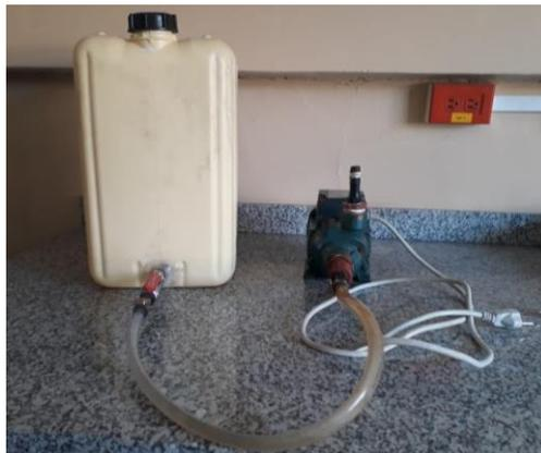
**Imagen 7.** Recipiente de agua residual conectado a la bomba de agua.
