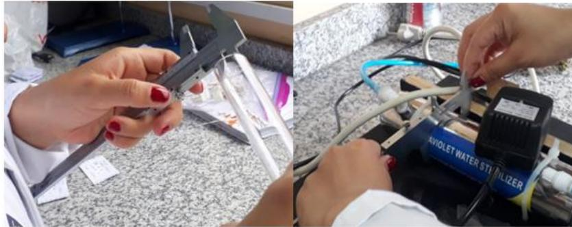
**Imagen 2.** Mediciones realizadas al tubo de vidrio y el cuarzo del reactor.
