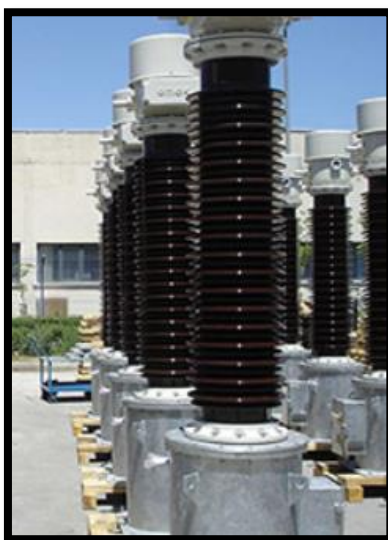
FIGURA 26: TRANSFORMADOR DE POTENCIAL. FUENTE: [3]
