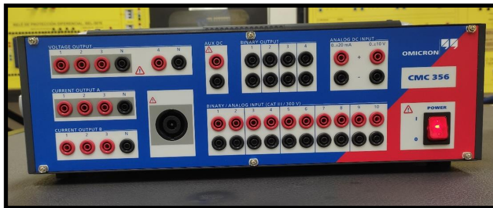
FIGURA 49: PARTE FRONTAL DE LA OMICRON CMC 356
