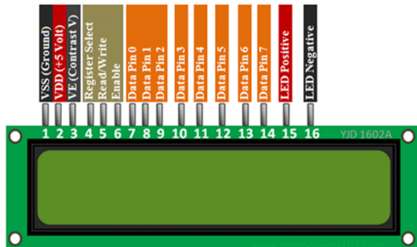
Figura 2.17 Diagrama de Pines Display LCD 16x2 Autor: (Microcontrollerslab, 2020)
