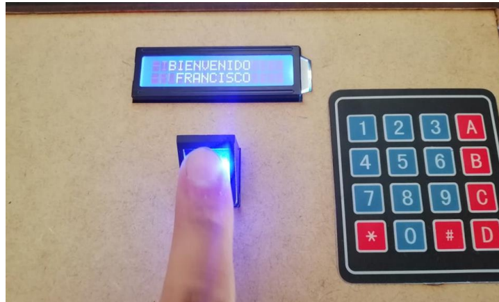
Figura 4.14 Habilitación del vehículo mediante huella dactilar Fuente: Autores.
