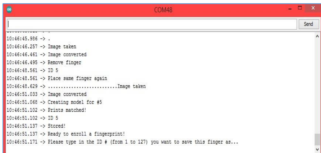
Figura 3.9 Registro de Huellas Dactilares en el sistema Fuente: Autores.
