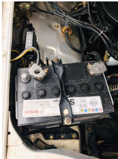
Figura 4.5 Batería desconectada de vehículo de pruebas Fuente: Autores.
