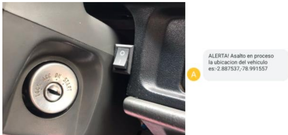
Figura 4.11 Mensaje de alarma con coordenadas del vehículo
