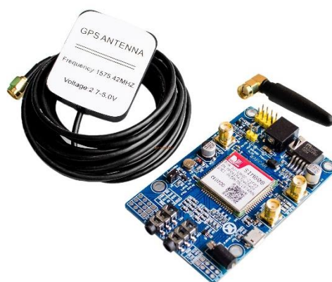
Figura 2.13 Módulo Arduino SIM808 GSM/GPRS/GPS Autor: (Prometec, 2017)
