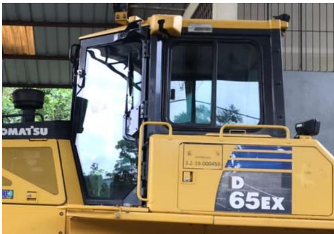
Por el exterior, del chasis y la carrocería están deteriorados, la pintura y la estructura metálica presentan ralladuras, también se constata que dispone de: faros delanteros, y el tren de rodaje por orugas está deteriorado por esta unidad se encuentra fuera de funcionamiento.
