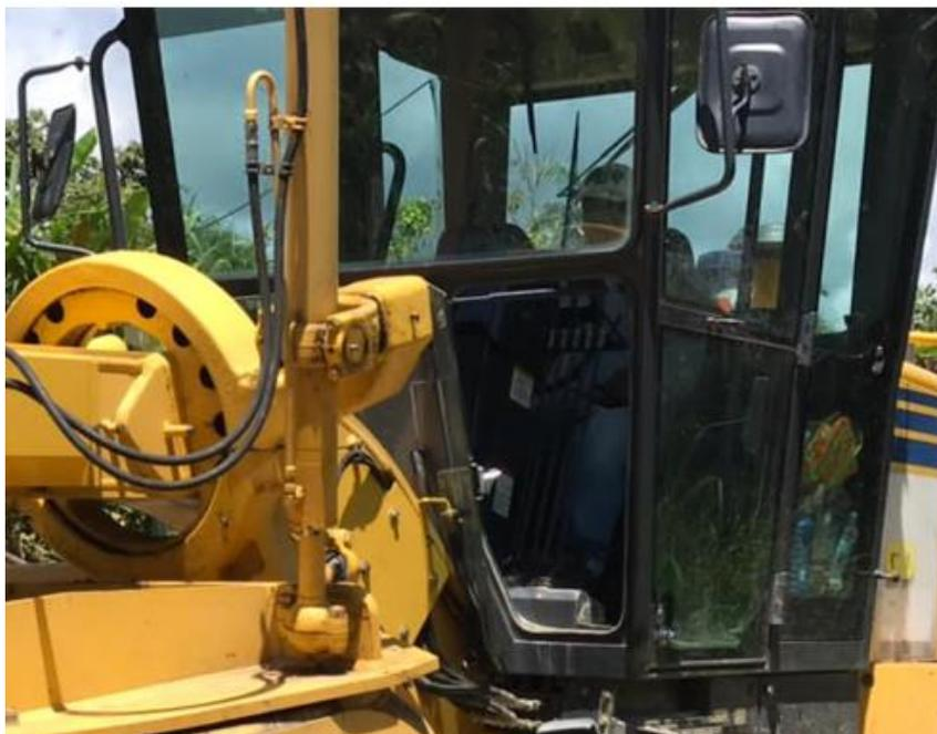
En la parte exterior, la carrocería presenta deterioro de la pintura en la parte frontal, además su estructura metálica muestra ralladuras, también se constata que dispone de: faros delanteros, retrovisores y el tren de rodaje de esta unidad está en buen estado.
