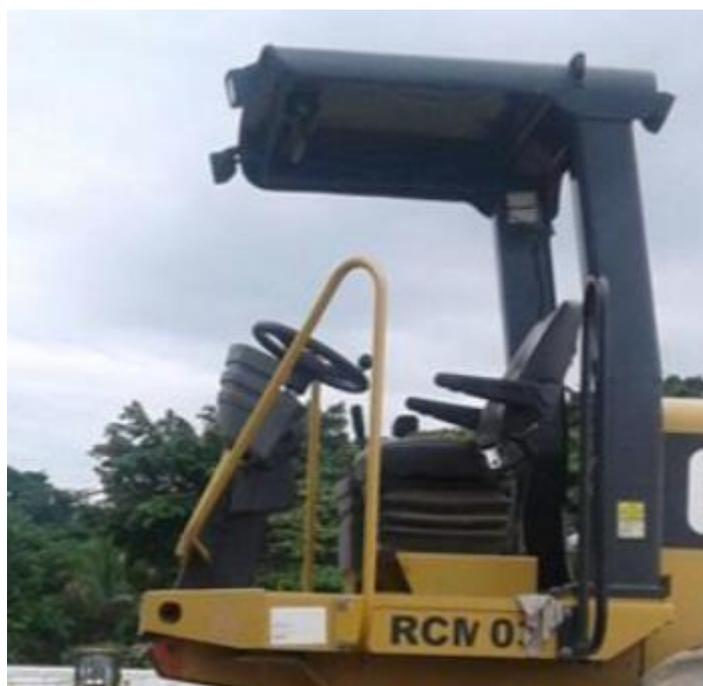
En la parte exterior, la carrocería se pudo evidenciar que la pintura mantiene su aspecto, su estructura metálica se encuentra en buen estado, también se constata que dispone de faros delanteros para el trabajo y la transmisión hidrostática de esta unidad se encuentra en buen estado
