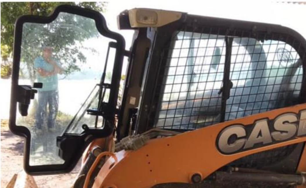
En la parte exterior, la carrocería se pudo observar que la pintura mantiene su aspecto, además su estructura metálica se encuentra en buen estado, también se constata que dispone de: faros delanteros para el trabajo y el tren de fuerza motriz de esta unidad se encuentra en buen estado
