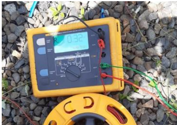
Figura 3.8. Resistencia medida a 6 metros de separación sobre el eje X
