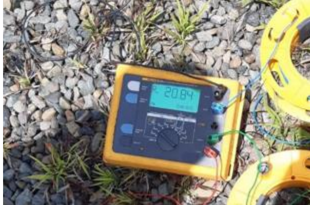
Figura 3.5. Resistencia medida a 1 metro de separación sobre el eje X
