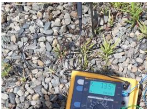
Figura 3.9. Resistencia medida a 1 metro de separación sobre el eje Y
