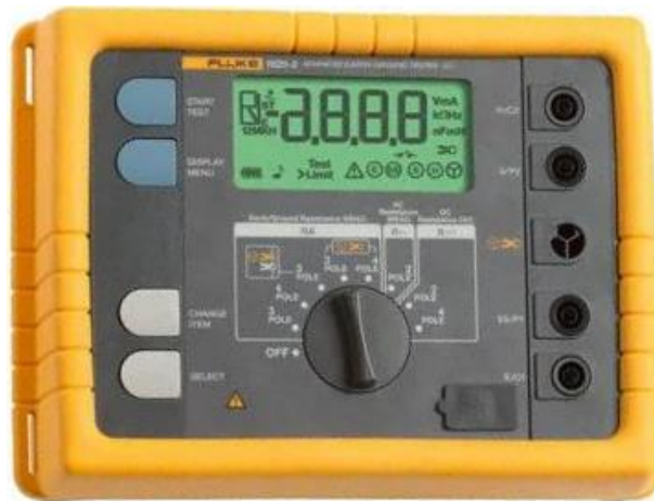
Figura 3.1. Comprobador de puesta a tierra Fluke 1625-2
