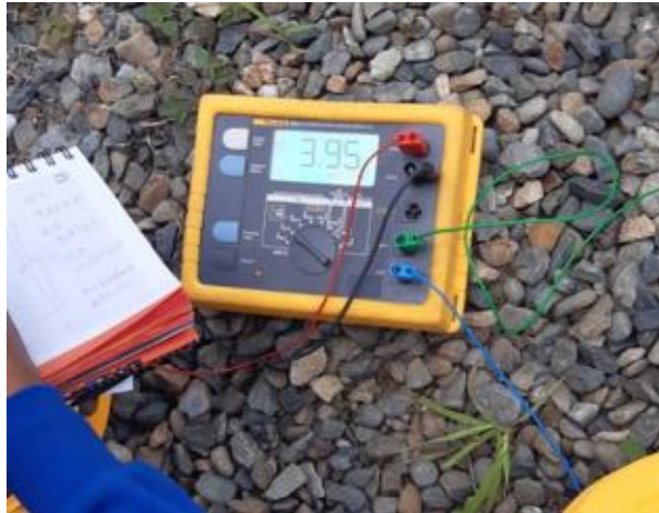
Figura 3.6. Resistencia medida a 2 metros de separación sobre el eje X
