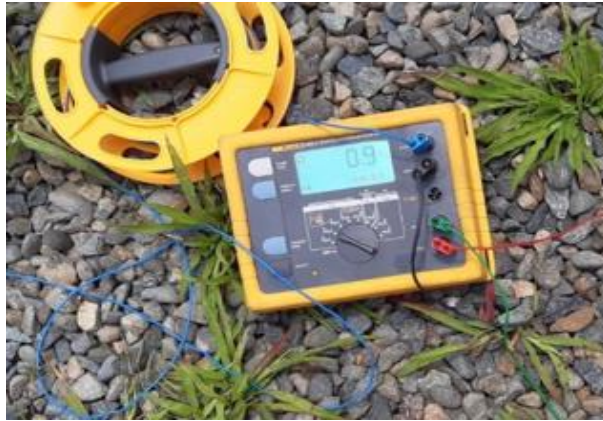
Figura 3.7. Resistencia medida a 3 metros de separación sobre el eje X
