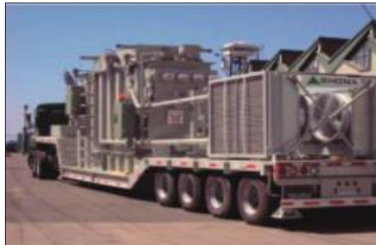
Figura 1.7. Subestación eléctrica móvil
