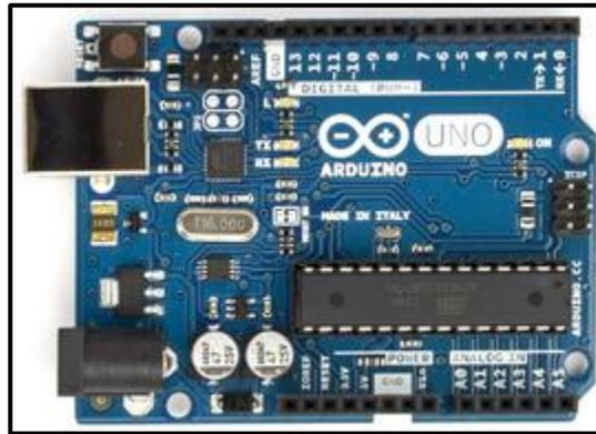
Figura 43: Arduino uno. Fuente: (Autores)
