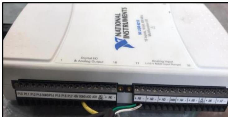
Figura 65: Conexión del sensor de torsión. Fuente: (Autores)
