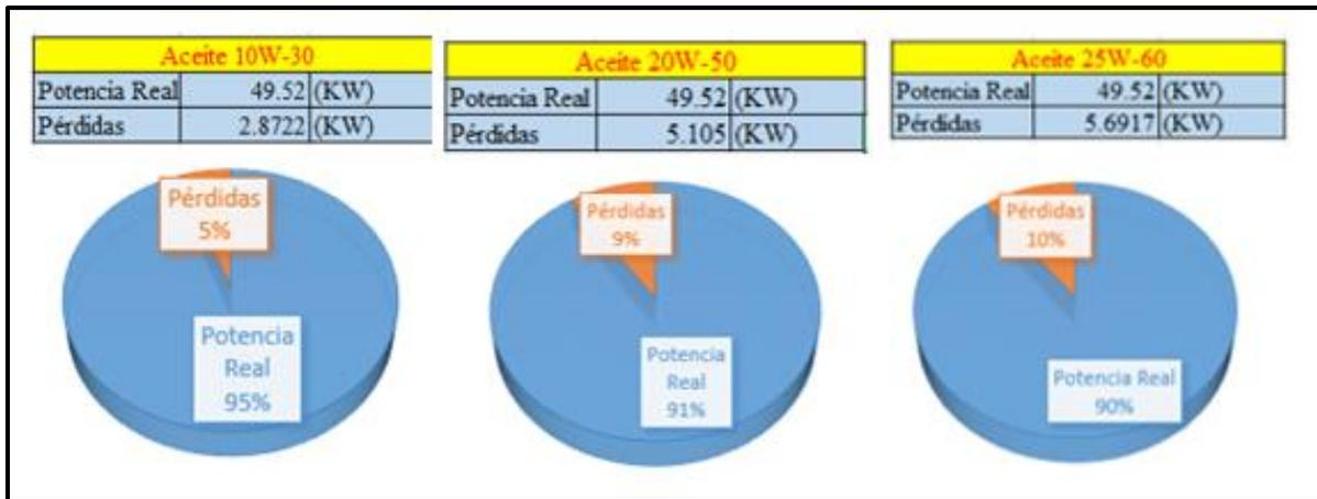
Figura 94: Eficiencia del motor con diferentes lubricantes. Fuente: (Autores)
