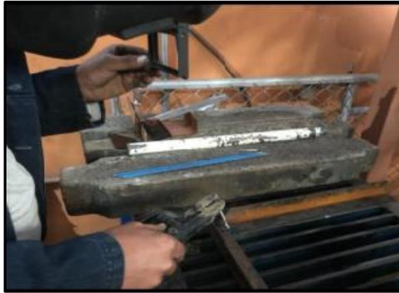
Figura 51: Bases para el motor eléctrico. Fuente: (Autores)
