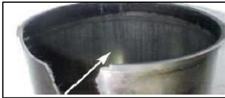
Figura 28: Desgaste generado por los segmentos del pistón en la camisa. Fuente:(López, 2018)
