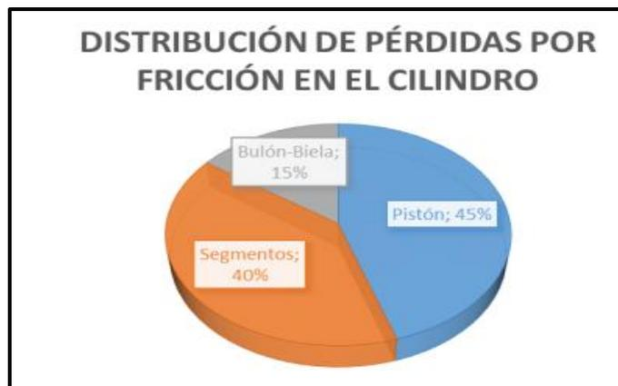
Figura 29: Distribución de pérdidas por fricción en el cilindro. Fuente: (Iniesta, 2016)
