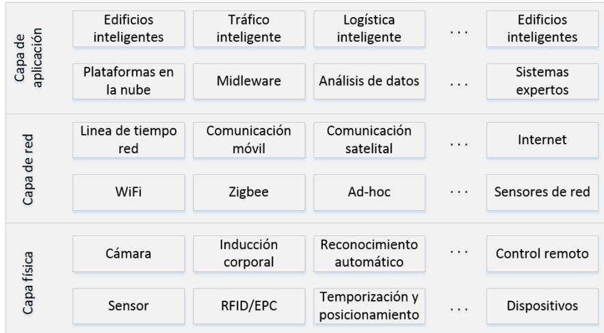
Figura 2.2: Modelo Arquitectónico de IoT (figura tomada y traducida de (Zhu y cols., 2017))
