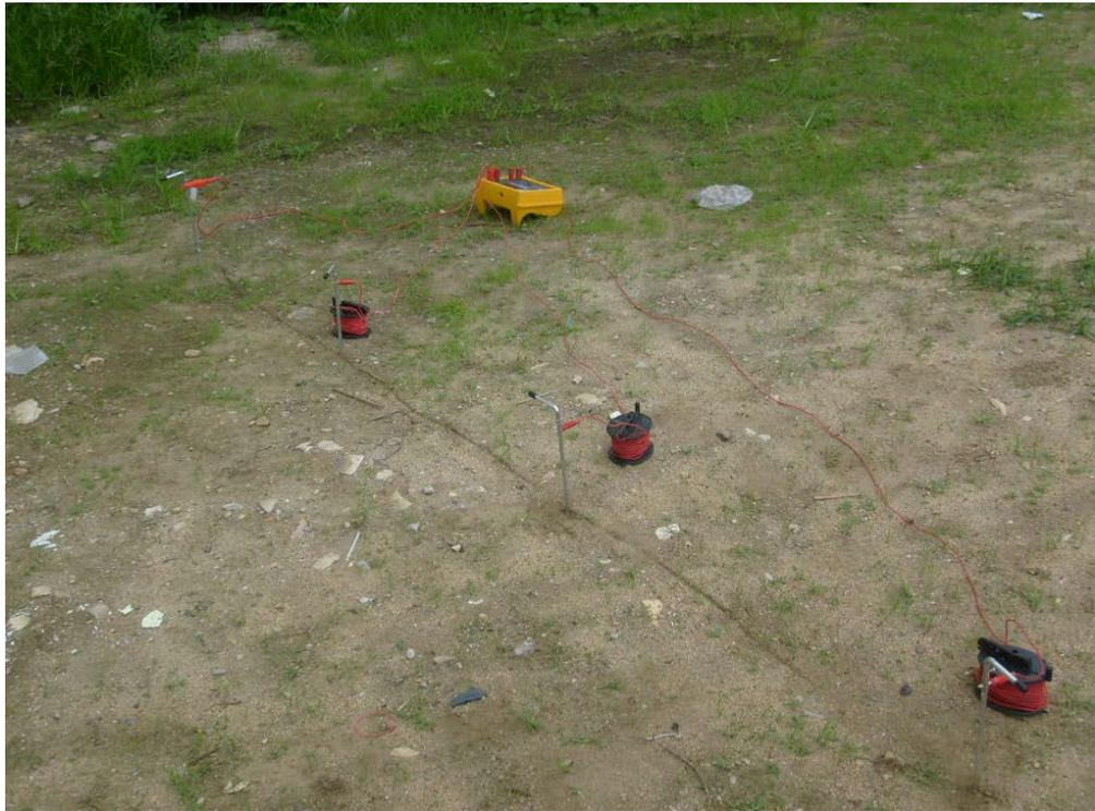
**Foto 4.4:** Medición de Resistencia según el Método de Wenner
