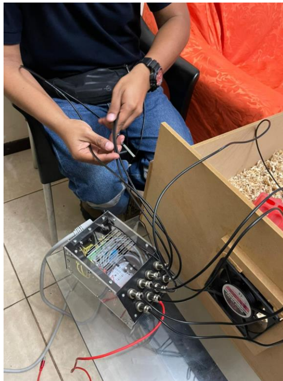
Figura 4.13 Conexión de los sensores y ventilador al prototipo IoT Avicultura
