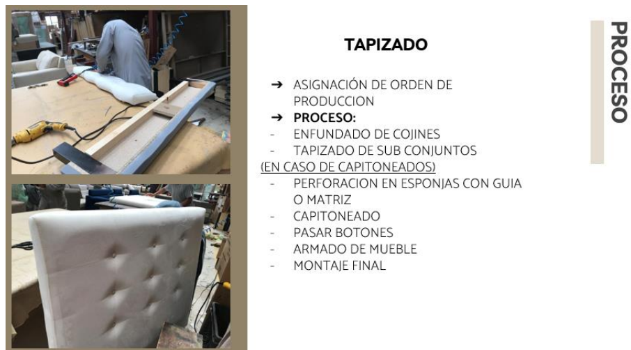
Figura 32 Proceso de trabajo en la sección de tapicería [26].
