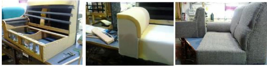
Figura 37 Proceso de tapizado de un sofá [9].
