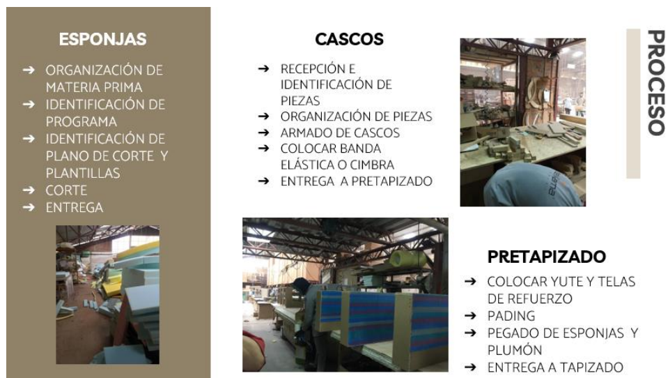
Figura 30 Proceso en la sección de Casco, Esponjas y Pretapizado [26].
