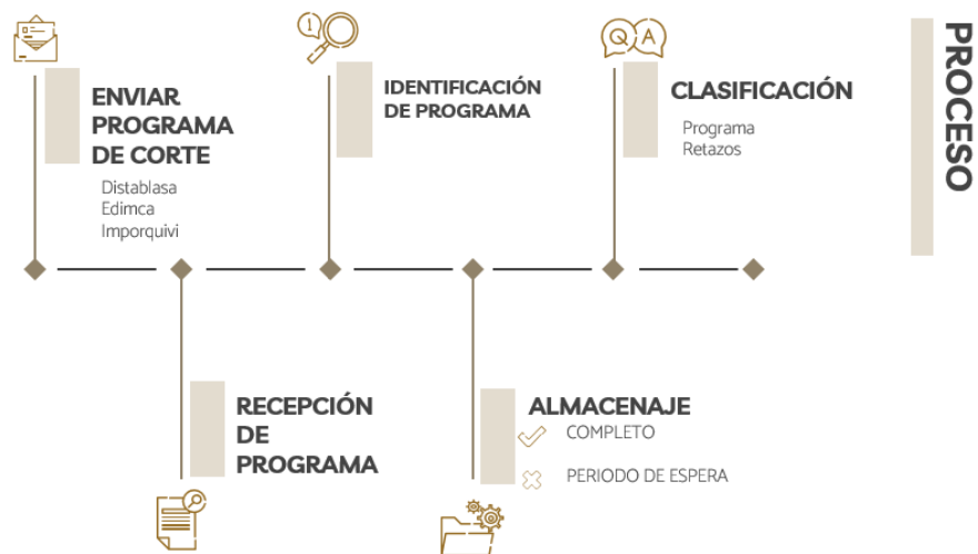
Figura 25 Proceso de trabajo en la sección preparación de tableros [26].
