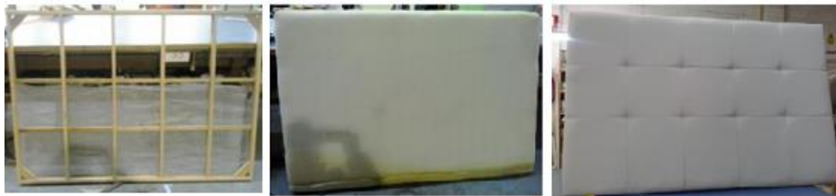
Figura 36 Proceso de tapizado de un cabecero de cama [9].
