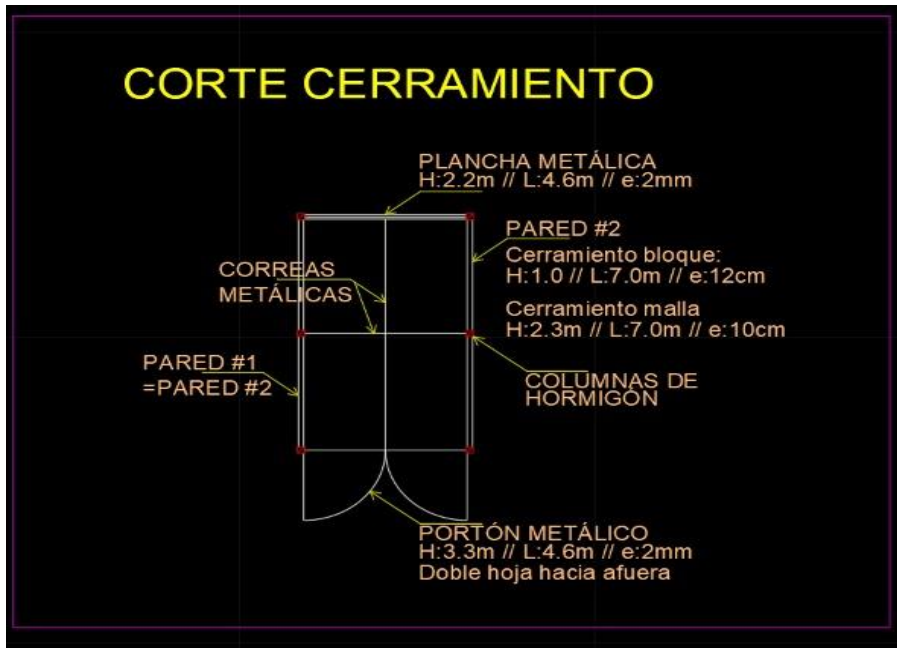
Figura 6. Medidas para el corte de cerramiento
