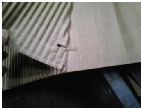
Figura 8. Prueba de desgarre manual
