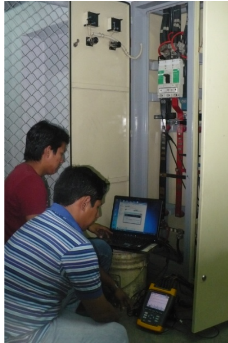
Fuente: Los Autores, Ilustración 27, Instalación del Analizador Fluke 435 dentro del tablero TDP2, 2010.
