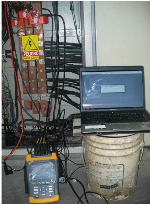
Fuente: Los Autores, Ilustración 25, Descarga de la información almacenada por el Analizador Fluke 435 al tablero de carga TDP1, 2010.
