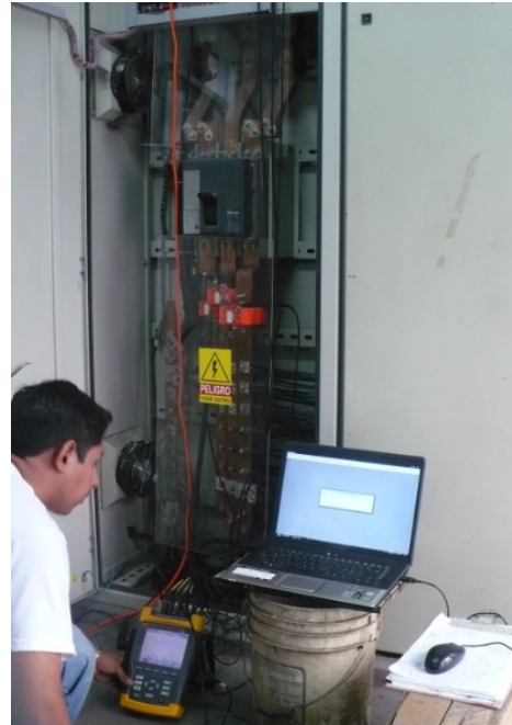
Fuente: Los Autores, Ilustración 25, Descarga de la información almacenada por el Analizador Fluke 435 al tablero de carga TDP1, 2010.
