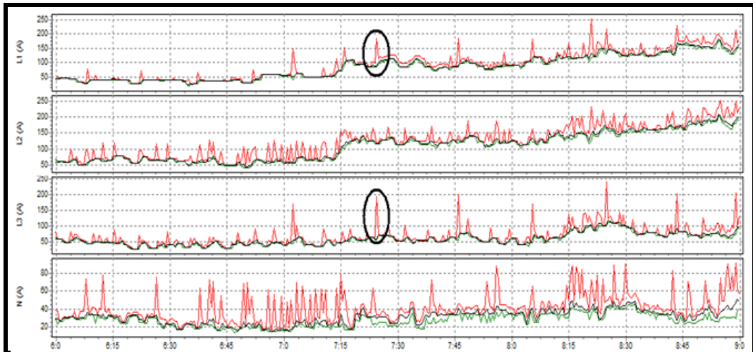
Fuente: Equipo FLUKE 435, Gráfico 30, Detalle de picos de amperajes en periodo de incremento de carga, 2010.
