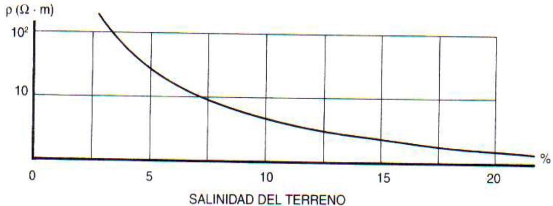
Figura 2.3. Variación de la resistividad del terreno en función de la salinidad.
