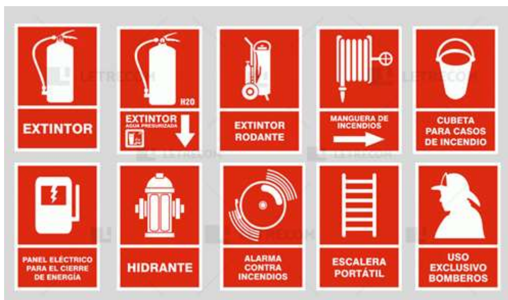
Figura 10. Señaléticas de Equipos Contra incendios [8].
