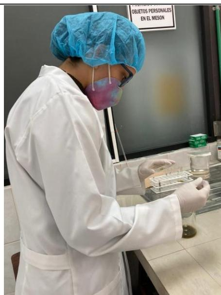
Foto 3. Colocación de la muestra ya mezclada en el vaso de precipitación para su posterior observación en el microscopio.
