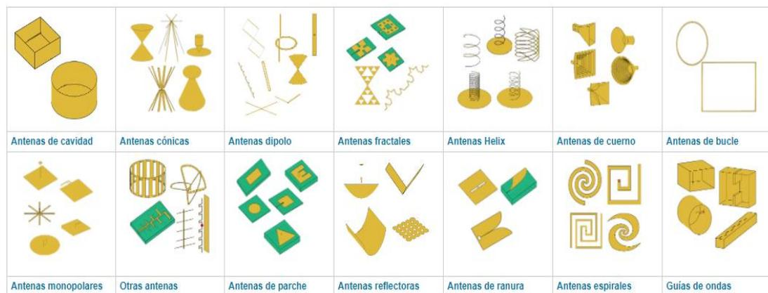
Figura 2.31 Catálogo de antenas
