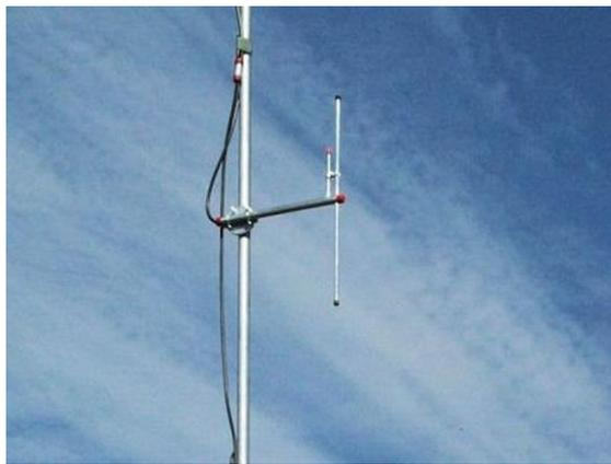
Figura 2.21 Antena dipolo
