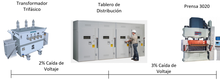
Figura 3.6: Caída de tensión en el sistema eléctrico.
