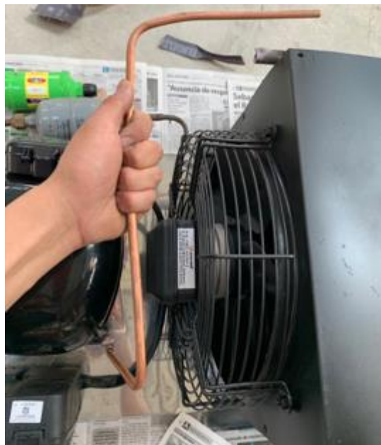
Figura 2. 19 Tubería de alta presión para refrigeración
