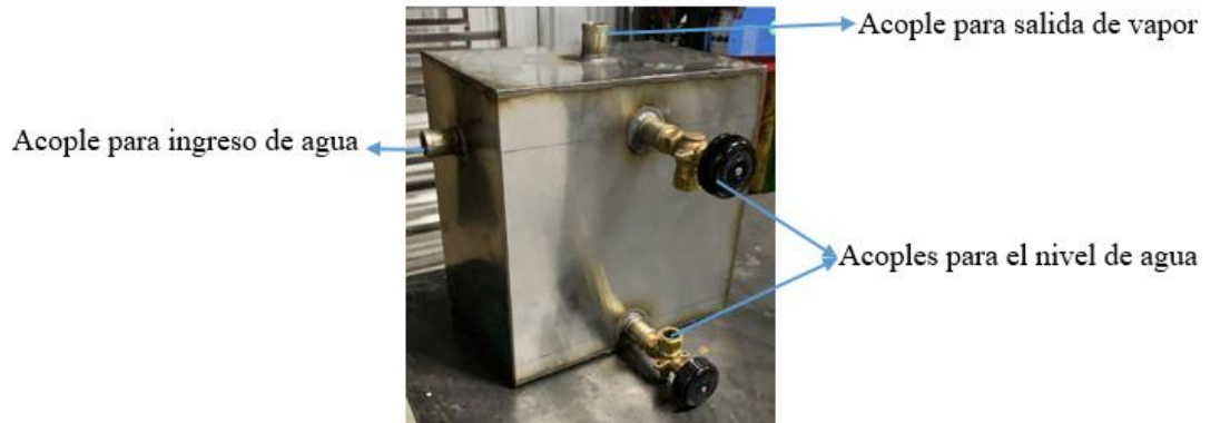
Figura 2. 27 Estructura del caldero de vapor con nivel de agua
