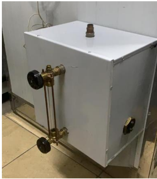
Figura 2. 28 Caldero de vapor forrado en lana de vidrio
