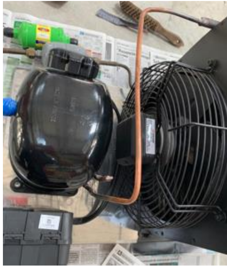
Figura 2. 20 Conexión de tubería la condensador
