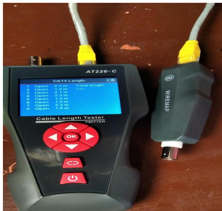
*Anexo 9 Resultado de la medición de longitud del cable UTP CAT 5e*
