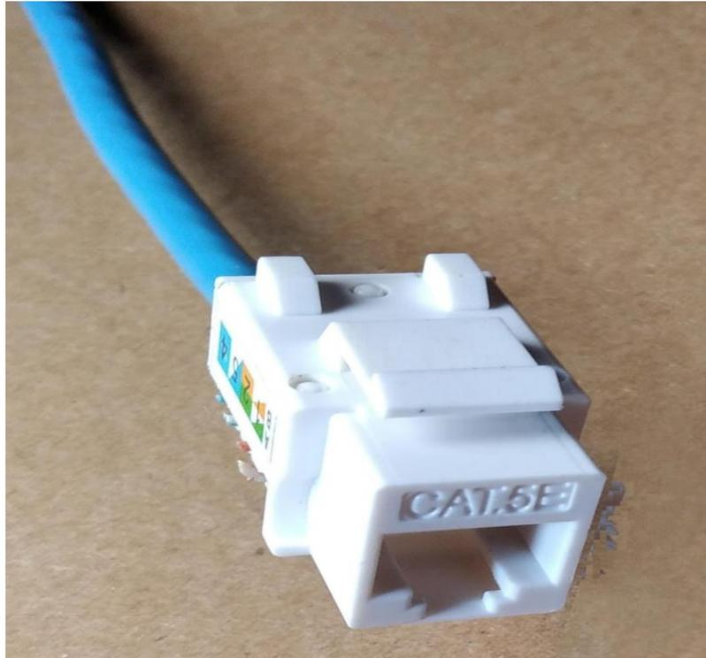
*Anexo 12 Resultado de conexión tipo B de un conector Rj45 hembra*
