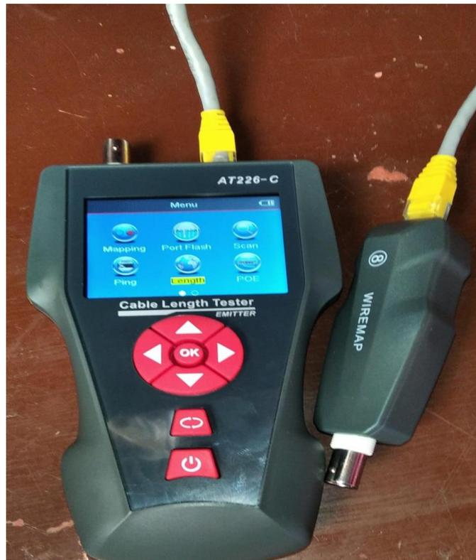
*Anexo 6 Funciones del Probador de cable de red AT226-C*
