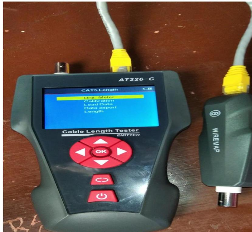
*Anexo 8 Función Length: determina la longitud de un cable UTP*
