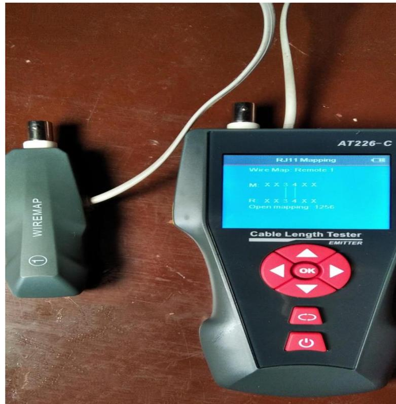
*Anexo 10 Conexión de cable Rj11*
