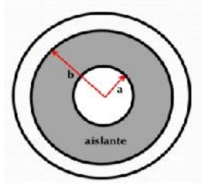
Ilustración 47 Diámetros Del Cable Coaxial
