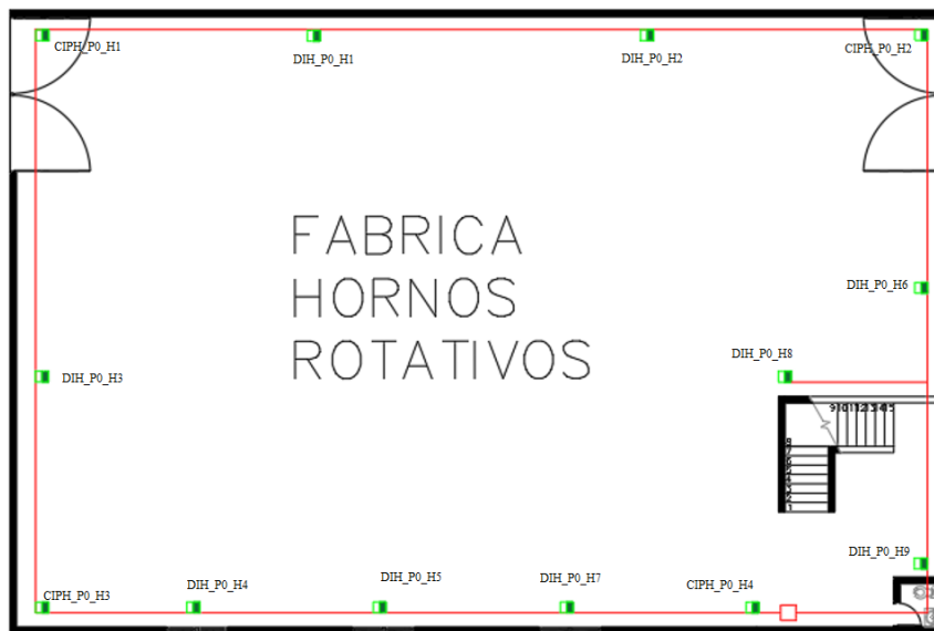
Figura 3.8 Cableado estructurado de la planta baja en el edificio de hornos.
