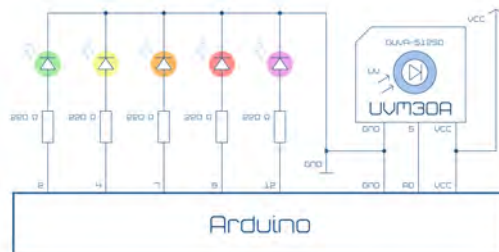
Figura 2.29: Implementación de semáforo UV con arduino, Sensor UVM30A.
