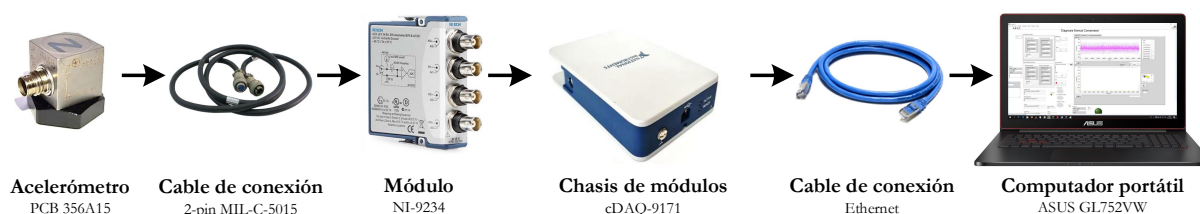
Figura 37: Secuencia de conexión del sistema de adquisición de señales de vibración. Fuente: [Autor].
