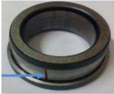
Figura 18: Fallo en pista interna. Fuente: [59].
