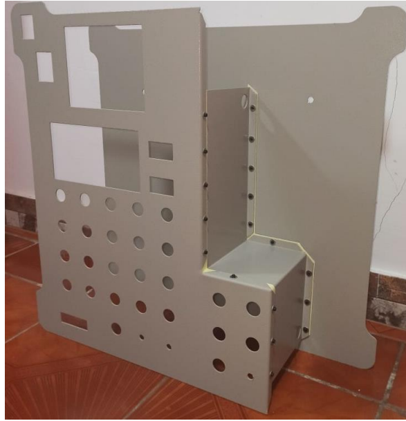
Figura 35. Unión de Plafones con tuercas remachables
