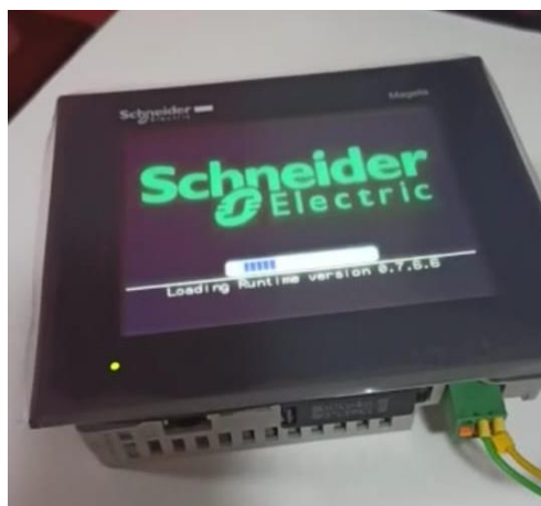
Figura 40. HMI GTO2310 energizado y encendido
