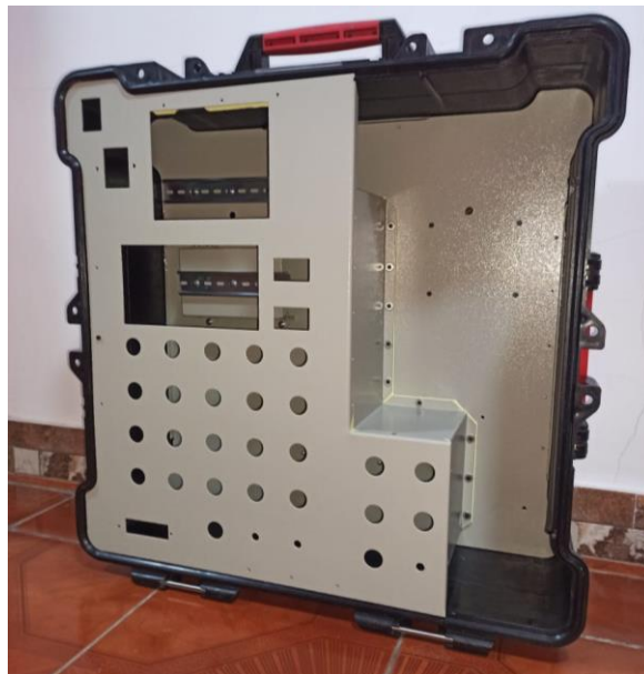
Figura 36. Ensamble de Plafones dentro de la Maleta Industrial
