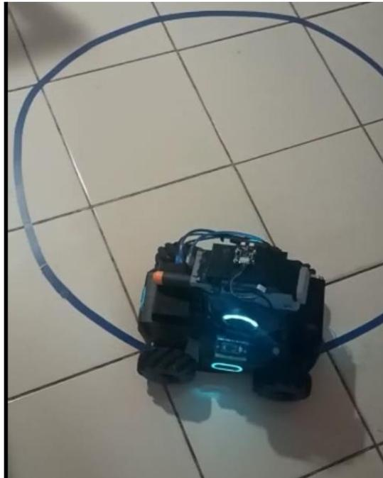
*Figura 0-4: Robomaster como seguidor de línea*
