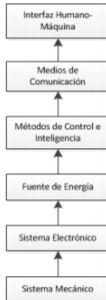
Figura 2-7: Arquitectura básica de un robot móvil [19]
