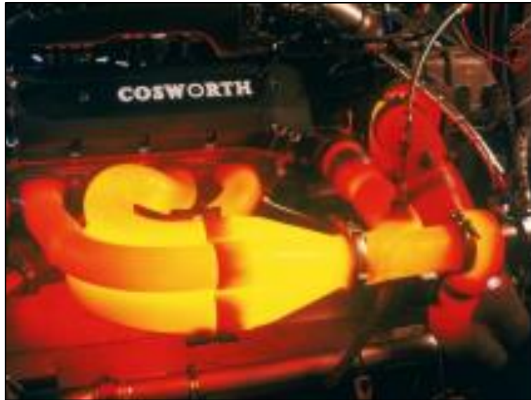
Figura 11. Transferencia de calor de los gases de escape a los conductos y al colector de escape. Fuente:(Saura Vidal, 2015).
