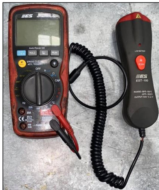
Figura 24. Pirómetro. Fuente: Autores.
