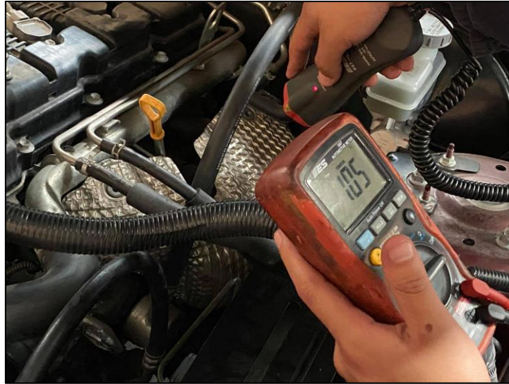
Figura 36. Medición de temperatura con el pirómetro. Fuente: Autores.
