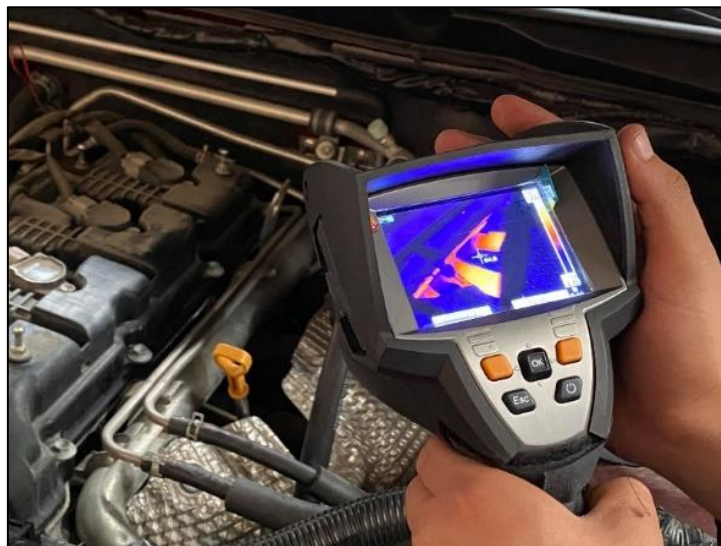
Figura 37. Medición de la temperatura del conducto escape con la cámara termográfica. Fuente: Autores.
