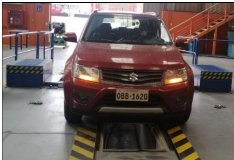
Figura 40. Vehículo de pruebas ubicado en el banco dinamométrico. Fuente: Autores.
