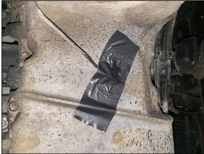
Figura 34. Sujeción de la termocupla tipo K sobre la pared externa del cárter. Fuente: Autores.
