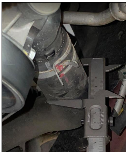
Figura 44. Medición del diámetro externo de la manguera de salida del refrigerante. Fuente: Autores.
