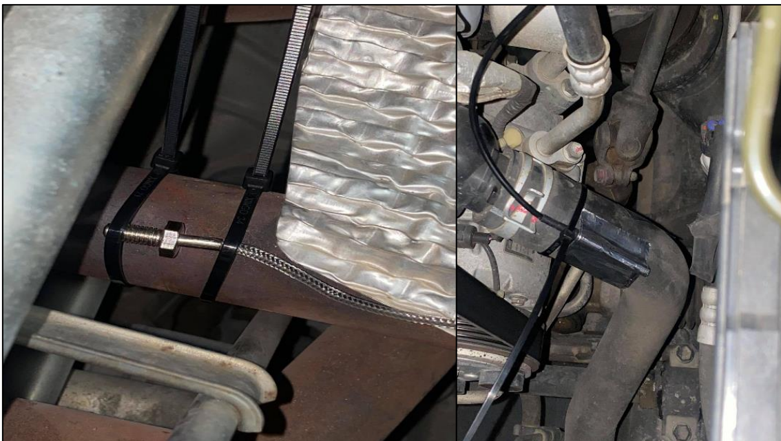
Figura 35. Sujeción de los sensores de temperatura en el conducto de escape y en la manguera de entrada del refrigerante. Fuente: Autores.
