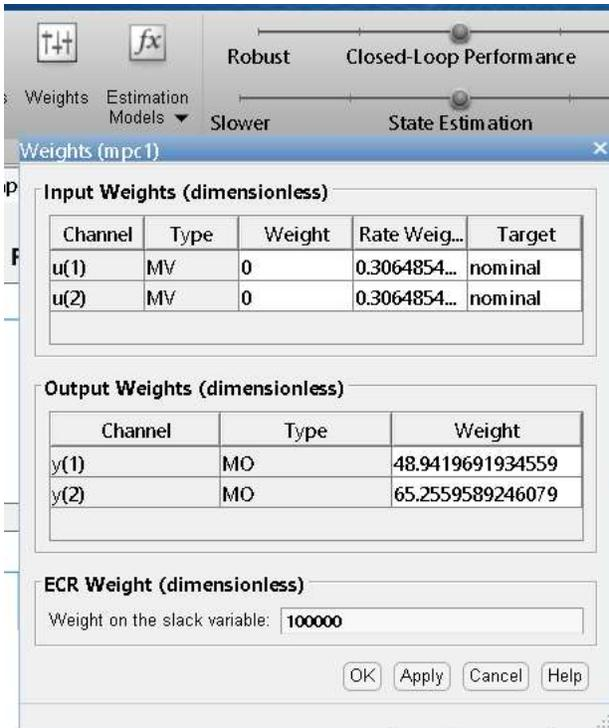
**Figura 67. Sintonización del controlador**
