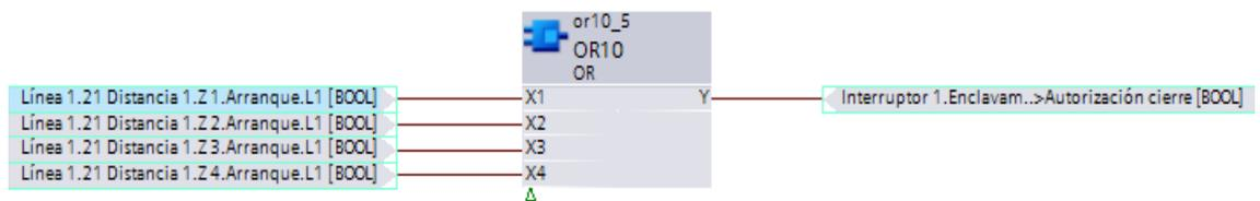
*Figura 32. Enclavamiento del interruptor mediante el arranque de las zonas de protección.*
