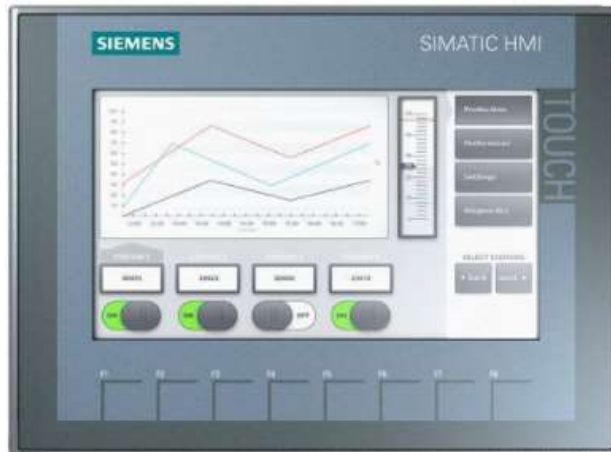
Figura 29. Pantalla touch KTP-700 (FESTO, 2019)
