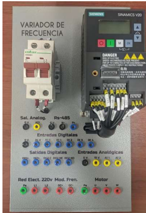
Figura 37. Panel variador de frecuencia.
