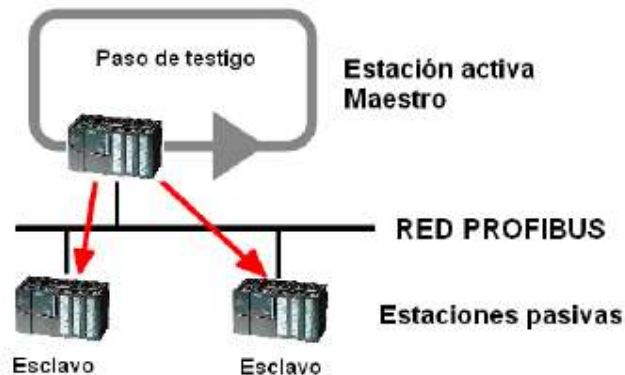
Figura 12. Configuración maestro esclavo (infoPLC, 2017)
