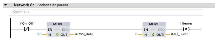
Figura 279. Función acondicionamiento de la señal de salida aplicada al calentador, Practica 9.
