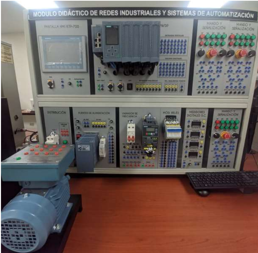
Figura 43. Modulo didáctico de redes industriales y sistemas de automatización.
