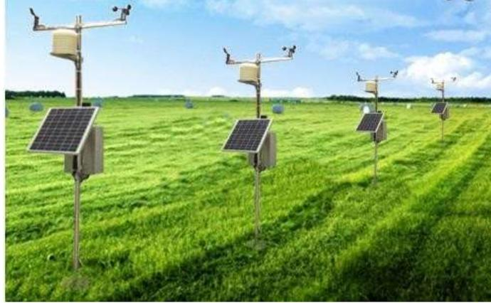
Figura 2.23 Estación meteorológica para la agricultura
