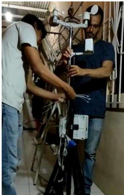
Figura 3.19 Conectorización de sensores meteorológicos
