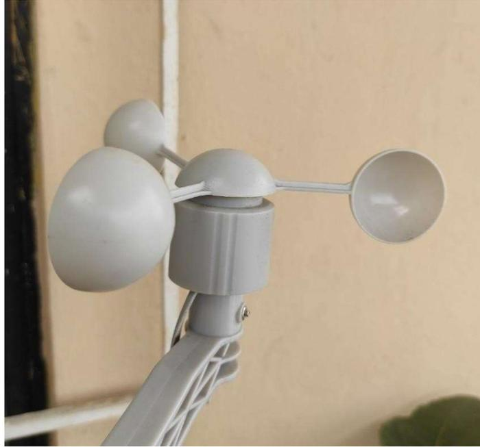
Figura 3.28 Sensor velocidad del viento
