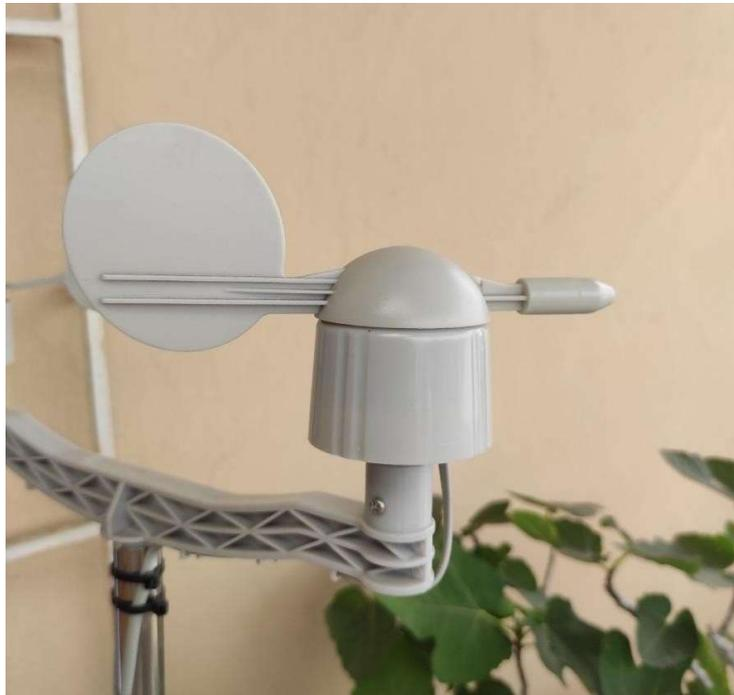
Figura 3.29 Sensor dirección del viento
