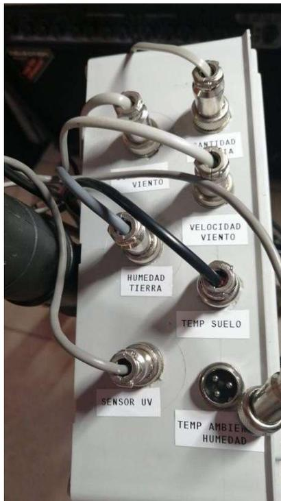
Figura 3.14 Etiquetado de los conectores de los sensores
