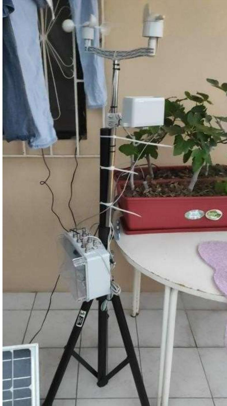
Figura 3.22 Prototipo IoT ensamblado
