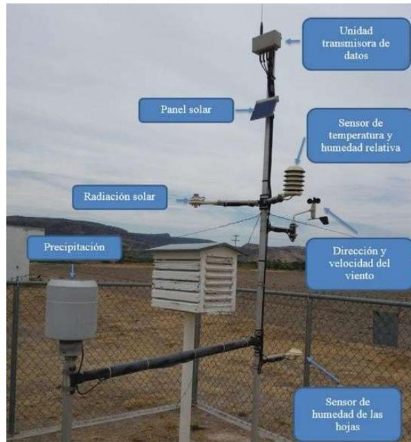
Figura 2.22 Estación meteorológica para la agricultura
