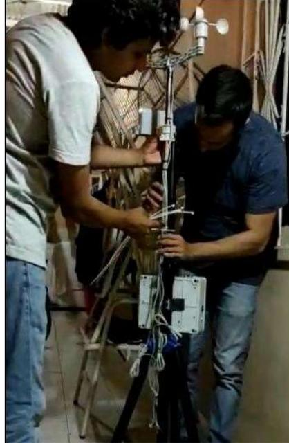
Figura 3.20 Ajustes con amarras de los cables del prototipo
