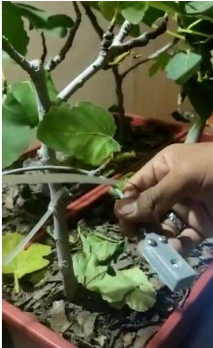
Figura 3.35 Colocación del sensor de humedad de suelo
