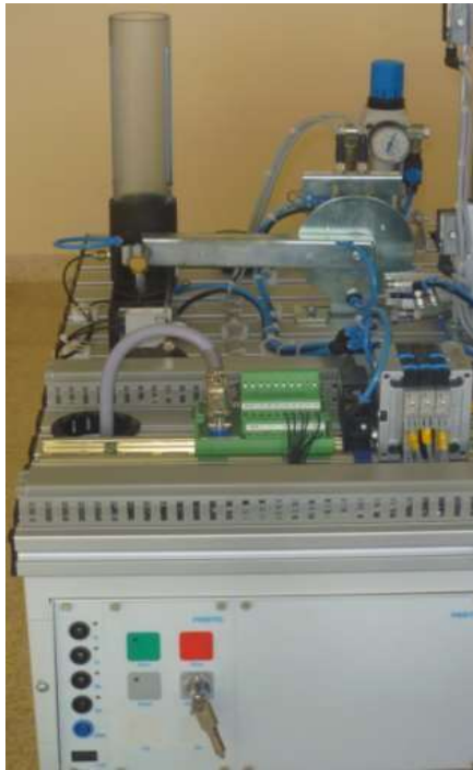
Figura 3. Estación de distribución [13]
