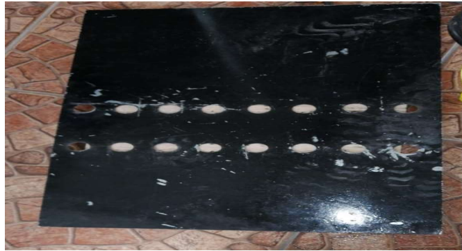
Figura 22. Calado, ponchado y pintado de láminas metálicas.
