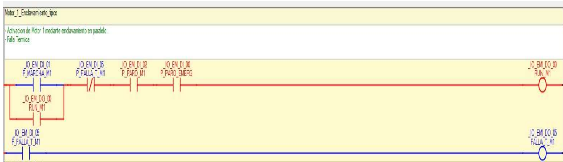
Figura 74. Activación del motor por contacto
